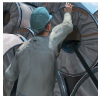
船積コイルの荷姿確認
